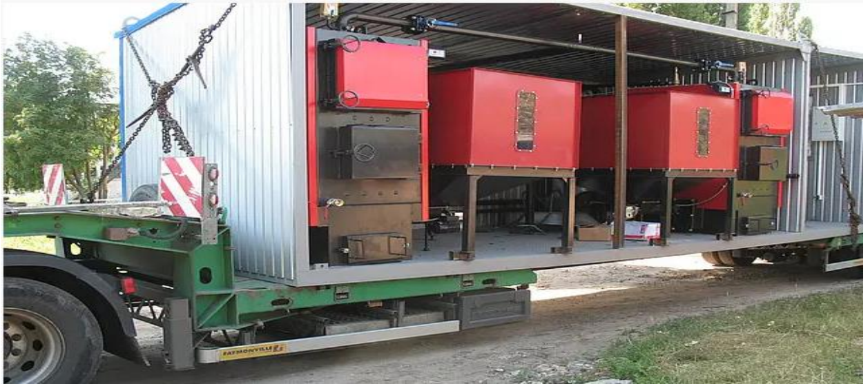
Рис. 2. Контейнерна транспортабельна котельня із вбудованою системою подачі сипучого твердого палива
