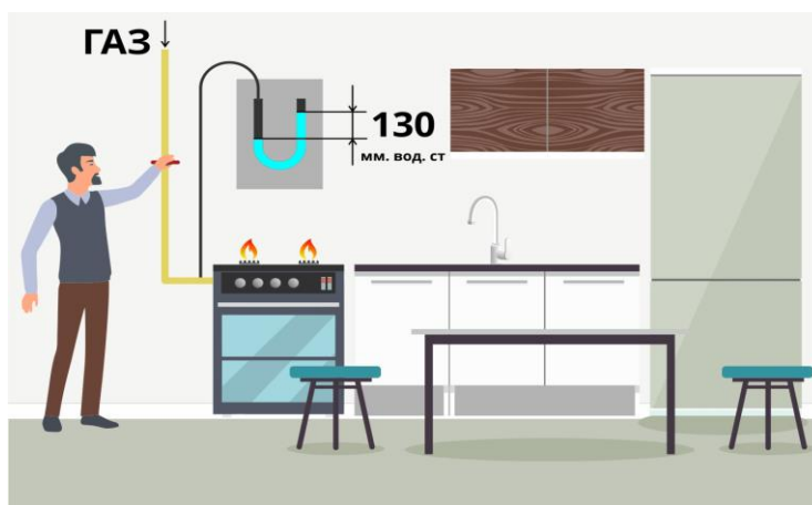
Рис. 2. Оптимальні умови роботи пальника газової плити
