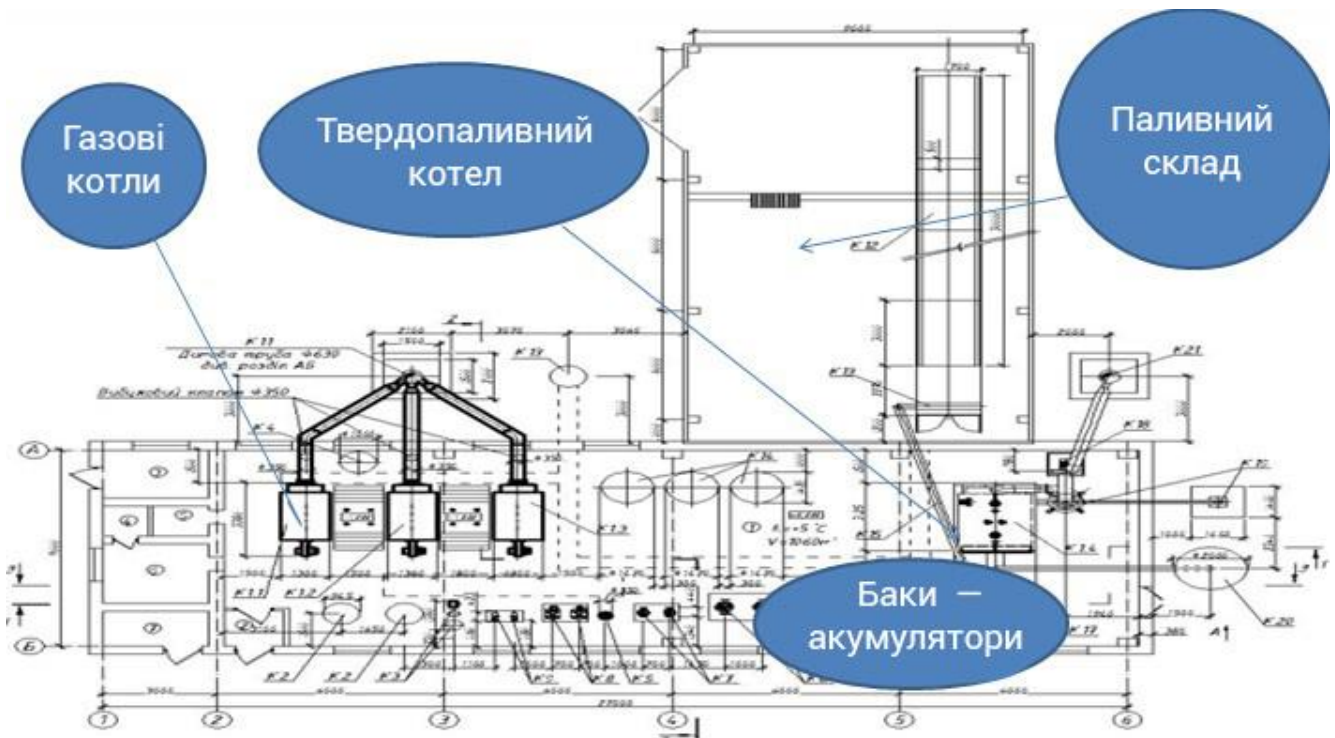
Рис. 1. План гібридної котельні із трьома котлами на природному газі і котлом на біомасі
